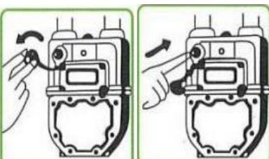
(三) 確認紅燈長亮後重新再閃爍(微電腦瓦斯表自動檢測漏氣)，約三分鐘後閃爍熄滅即可恢復使用天然氣。
